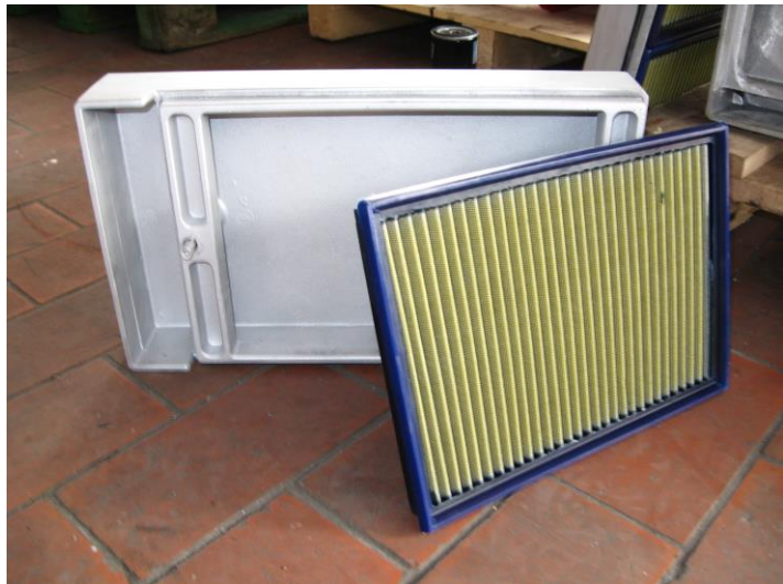
Ansaugdämpfer mit Filterwächter
